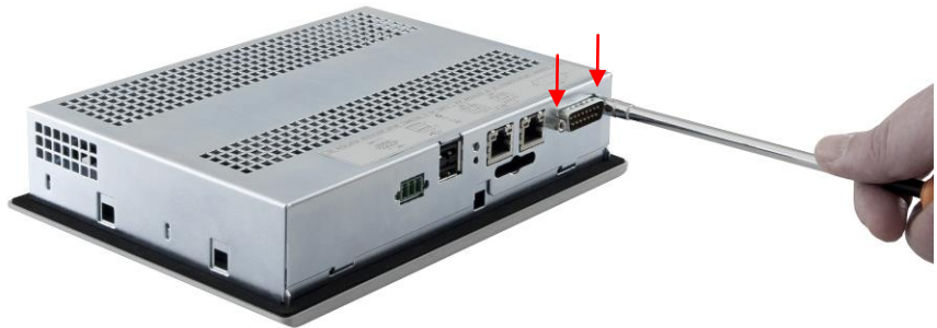
Abbildung 73 Backup Batterie Austausch
