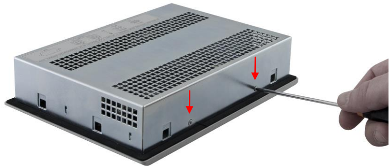
Abbildung 72 Backup Batterie Austausch
