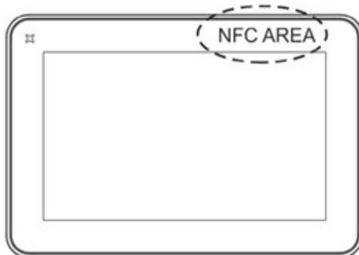
Abb. 5: Position der Antennen
