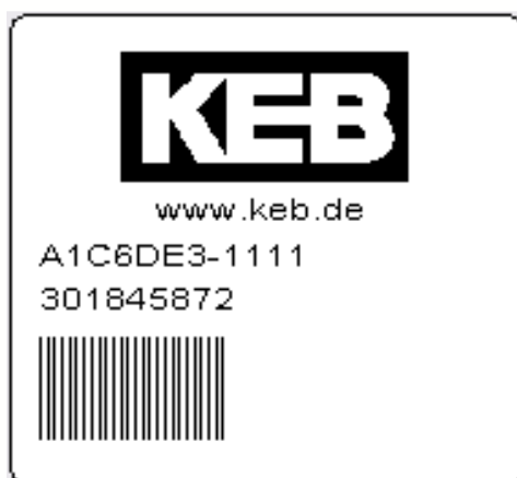
Beispiel Typenschild einer CF Karte mit Seriennummer (301845872)
