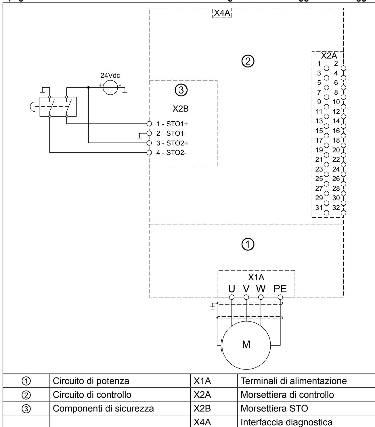
Il circuito visualizzato mostra errori di cablaggio nella zona del gruppo di arresto di emergenza e linea di alimentazione. Un eventuale cortocircuito sul lato primario del quadro di arresto di emergenza (massa e 24 Vdc) e un cortocircuito sul lato secondario dell'unità o nel cablaggio, conduce direttamente o con contatti chiusi, ad un corto circuito della rete, mediante il quale interviene il fusibile a 24V collegato in serie..
