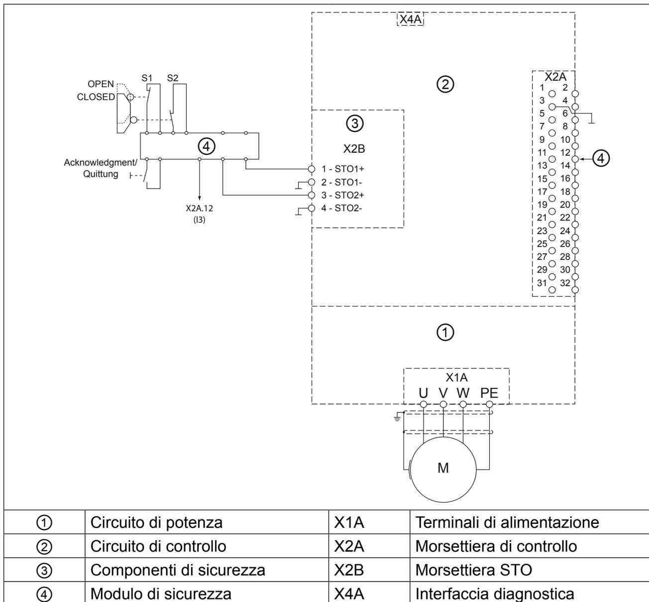
Con l'attivazione del dispositivo di arresto di emergenza l'azionamento viene arrestato con una rampa di decelerazione tramite X2A.12 ingresso (I3).
