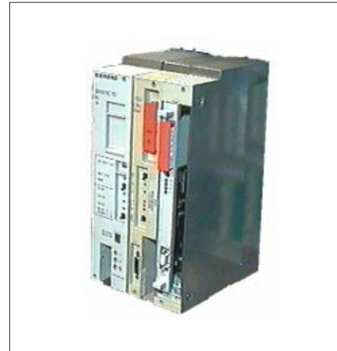
S5 mit IM308-B als PROFIBUS-DP-Master Programmierbeispiel
