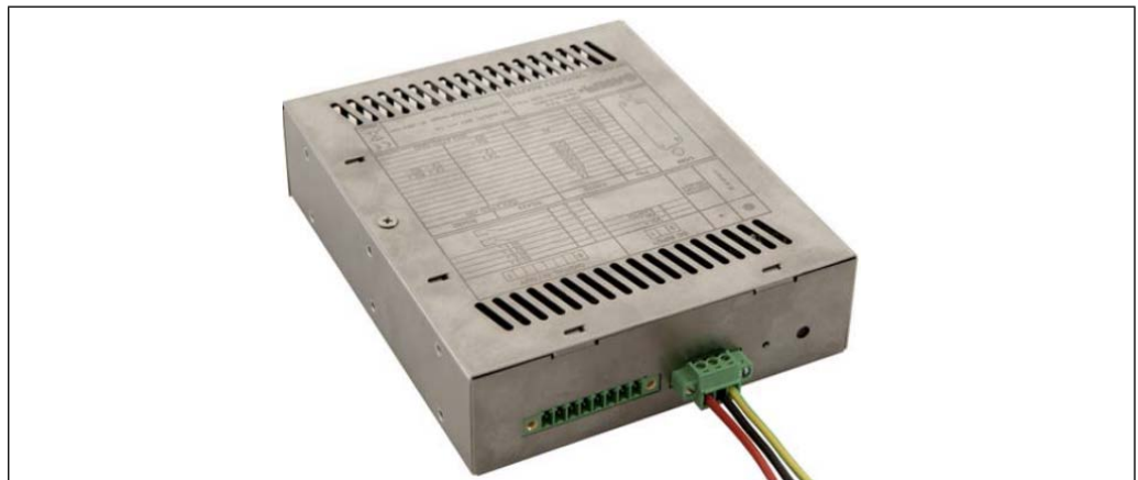
Abbildung 34: Anschlüsse für die Stromversorgung
