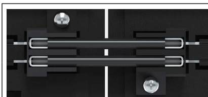
Abbildung 28: Anschluss des 24V-Busses
