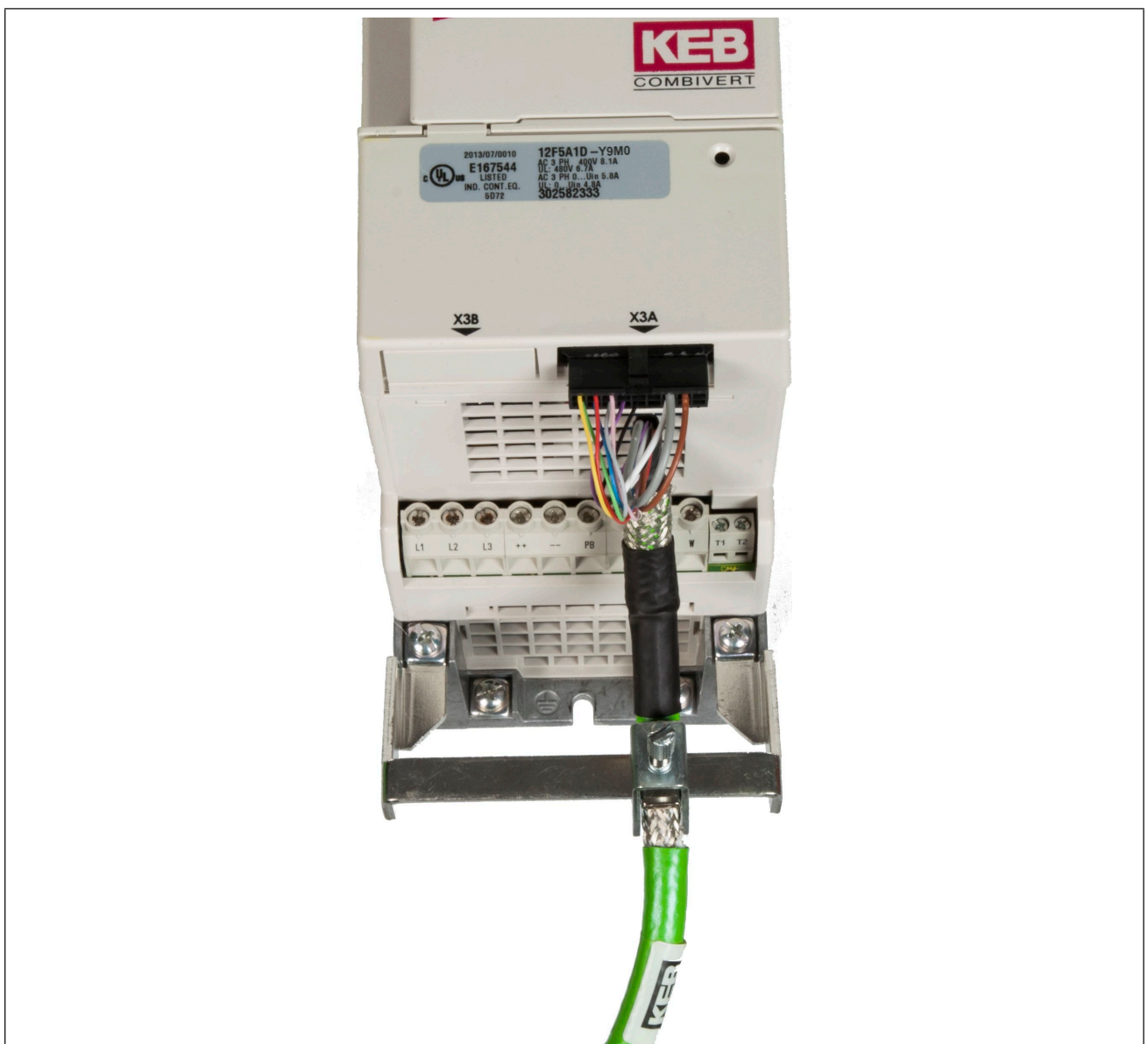
Abbildung 4: Geberkabelschirm mit Schirmklemme auf Erdungsbügel
