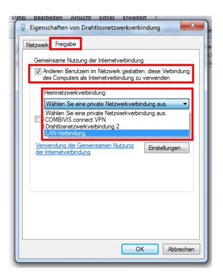
Unter dem Menü-Reiter "Freigabe" wählen Sie den Netzwerk-Port des C6HMIs / C6Routers aus, mit dem der Laptop verbunden ist.
