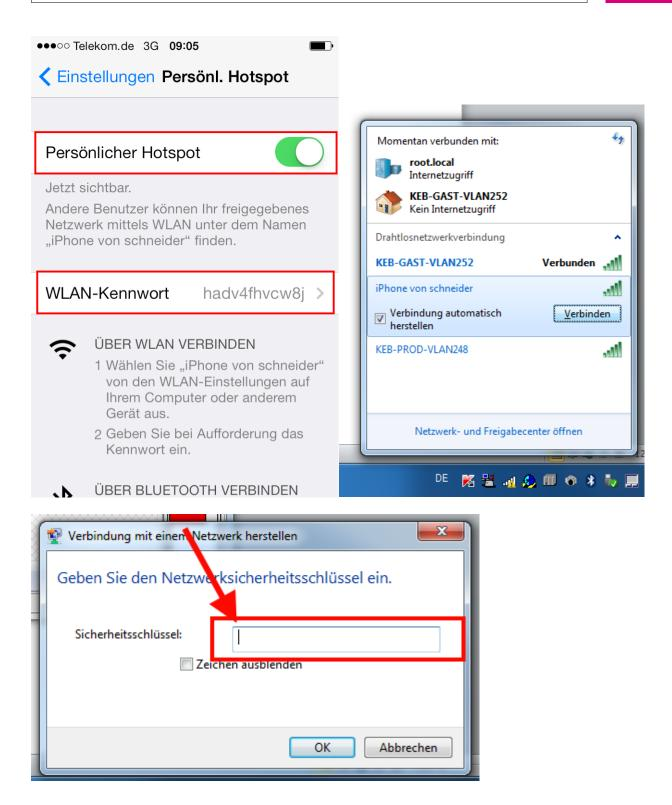
Um nun die Netzwerkverbindung an das C6HMI bzw. dem C6Router weiterzugeben, muss diese für weitere Teilnehmer freigegeben werden. Öffnen Sie zunächst das Netzwerk- und Freigabecenter und ändern Sie dort die Adaptereinstellungen.
