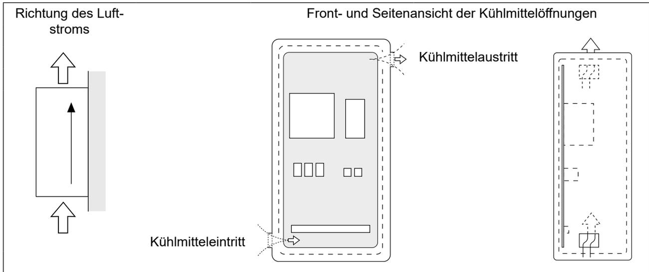
Abbildung 17: Schaltschranklüftung
