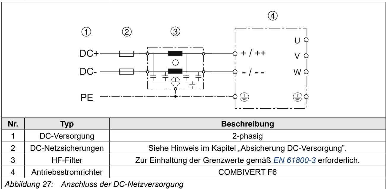
Abbildung 27: Anschluss der DC-Netzversorgung
