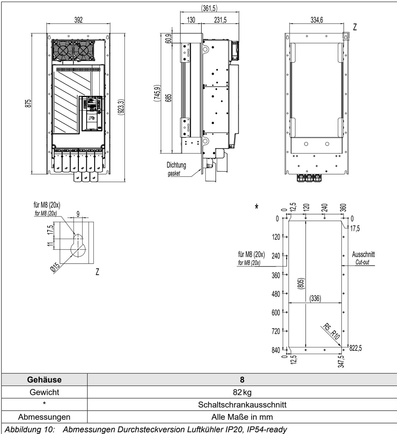
Abbildung 10: Abmessungen Durchsteckversion Luftkühler IP20, IP54-ready
