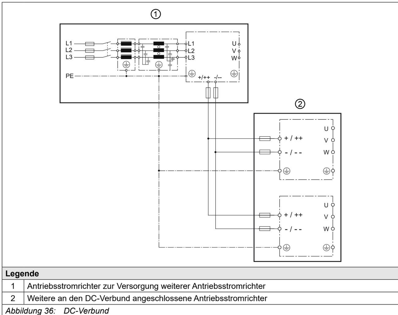
**① Bei Verwendung dieses Antriebsstromrichters zur Versorgung weiterer Antriebsstromrichter über die DC-Klemmen muss zusätzlich folgendes beachtet werden:**
