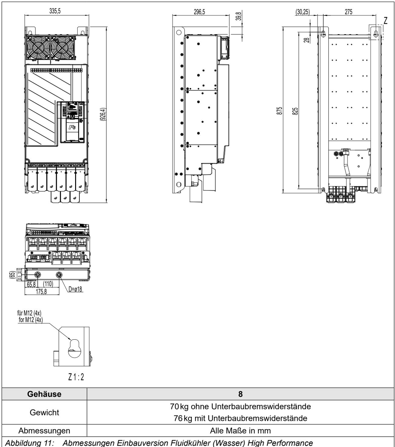
4.1.4 Durchsteckversion Fluidkühler (Wasser) High Performance IP20, IP54-ready
