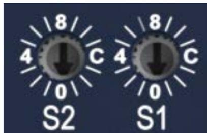
Abbildung 4: Drehcodierschalter am Antriebsstromrichter
