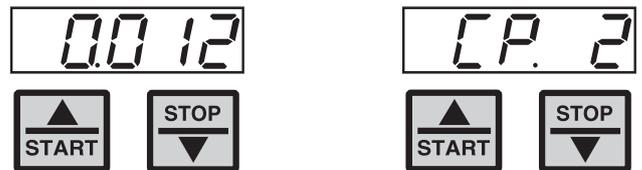
Grundsätzlich werden Parameterwerte beim Verändern sofort übernommen und nichtflüchtig gespeichert. Bei einigen Parametern ist es jedoch nicht sinnvoll, dass der eingestellte Wert sofort übernommen wird. Bei diesen Parametern (siehe Parameterübersicht) wird durch **ENTER** der eingestellte Wert übernommen und nichtflüchtig gespeichert.
