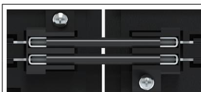
Die Brücke zur Verbindung des 24V-Busses wird den Geräten aufgesteckt und jeweils mit einer Schraube gesichert.
