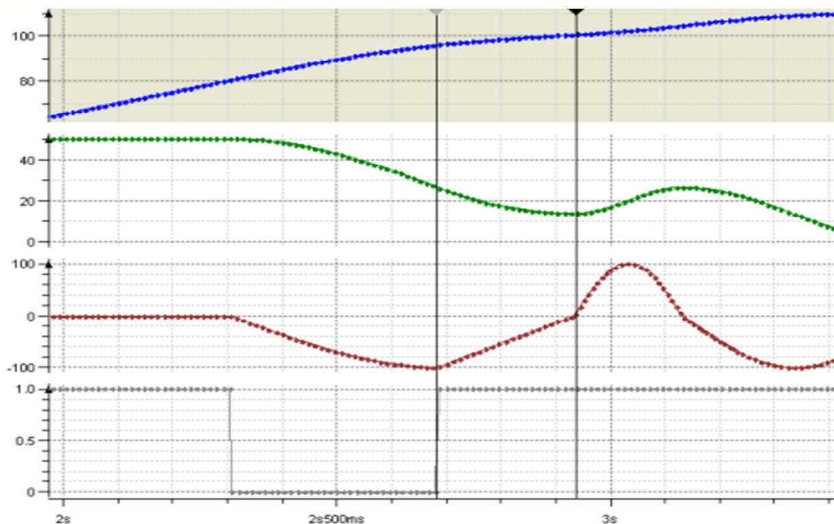
Ist der Jerk-Wert im Verhältnis zur Beschleunigung zu klein gewählt, kann diese Phase sehr lang werden und der Baustein führt eine scheinbar unkontrollierte Fahrt aus. Man sollte den Jerk-Wert so wählen, dass das Abrampen der Beschleunigung nur wenige Millisekunden dauert, z.B. Maximalbeschleunigung  $10.000 \text{ u/s}^2$ , Ruck  $1.000.000 \text{ u/s}^3$ , dadurch dauert diese Phase höchstens 10ms.
