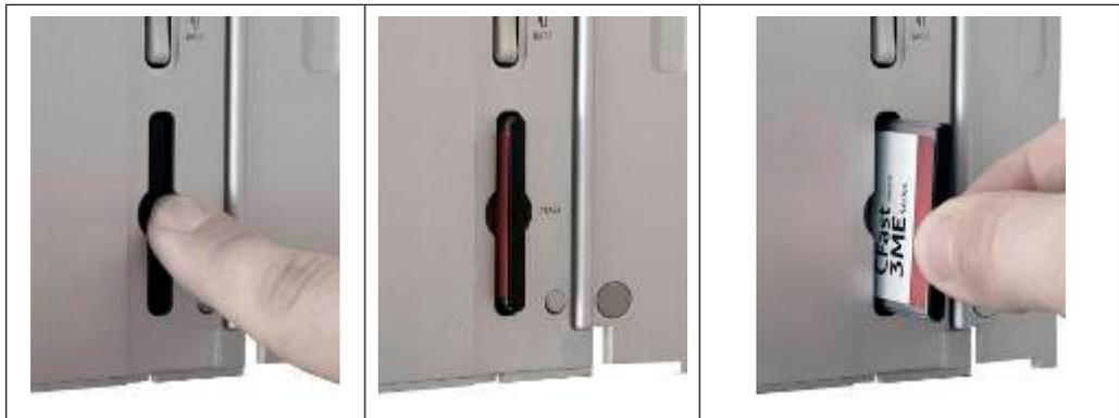
Abbildung 47: CFast-Einbau / -Ausbau
