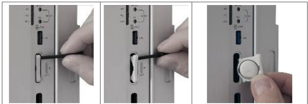
Abbildung 42: Batterieeinbau / -ausbau
