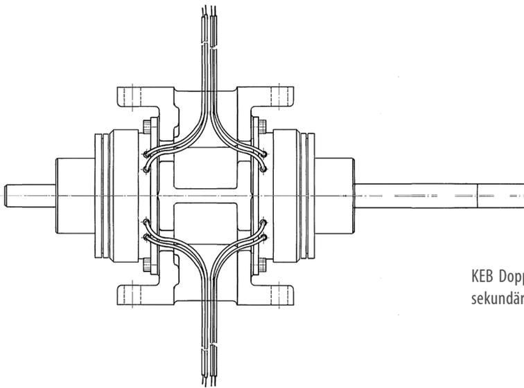
KEB Doppelkupplung für das Zu- und Abschalten von Motor und sekundären Anbauteilen
