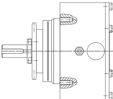
Einbaufertige KEB COMBIBOX zum Kuppeln und Abbremsen einer Riemenscheibe.
