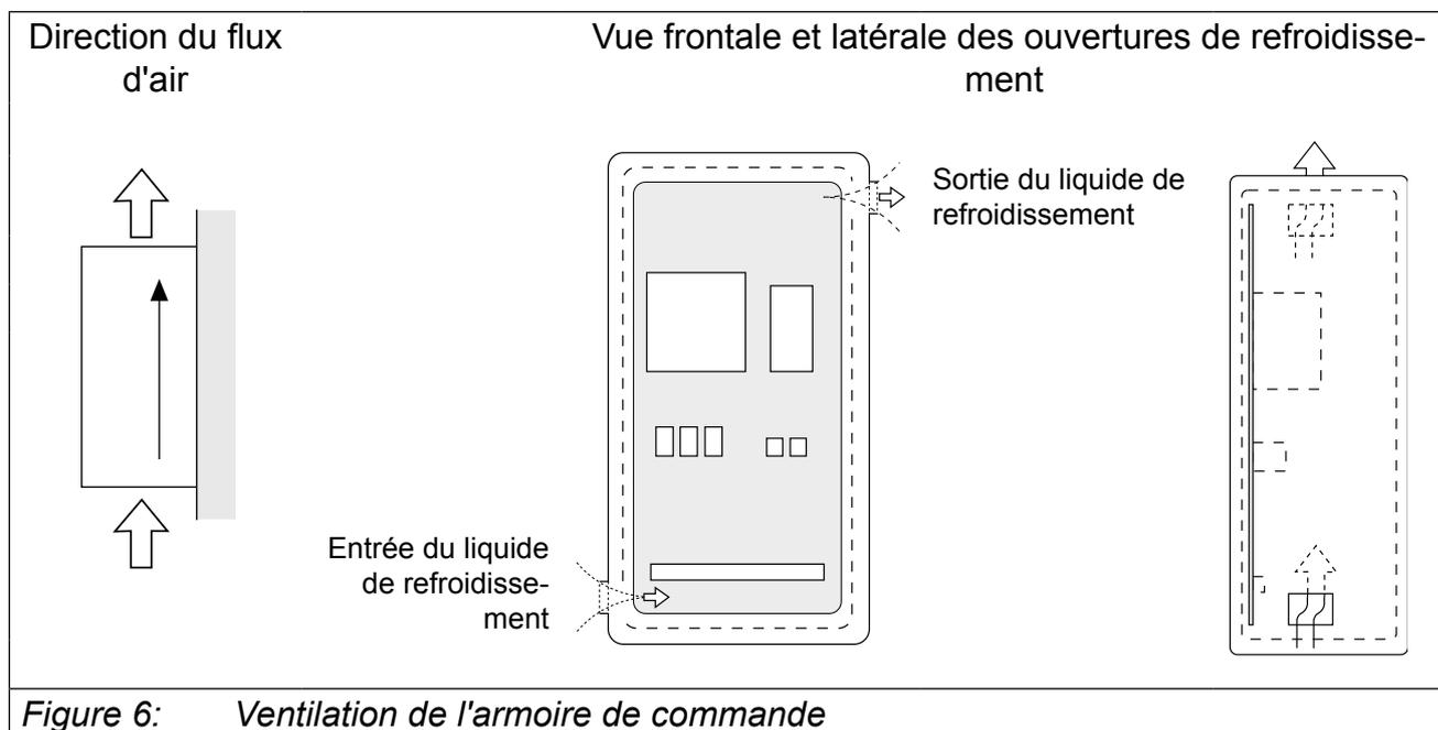
Figure 6: Ventilation de l'armoire de commande
