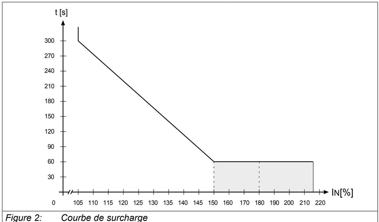
A partir de 105 % de charge le compteur incrémente. En dessous le compteur décrémente. Si l'intégrateur atteint la caractéristique de surcharge qui correspond au variateur, „ERROR overload“ apparaît.
