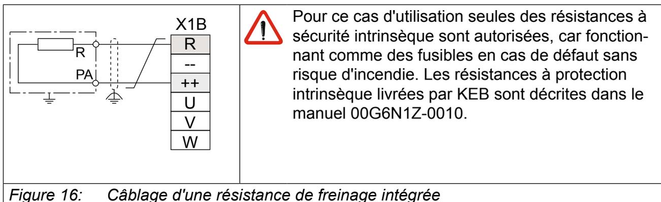
Figure 16: Câblage d'une résistance de freinage intégrée
