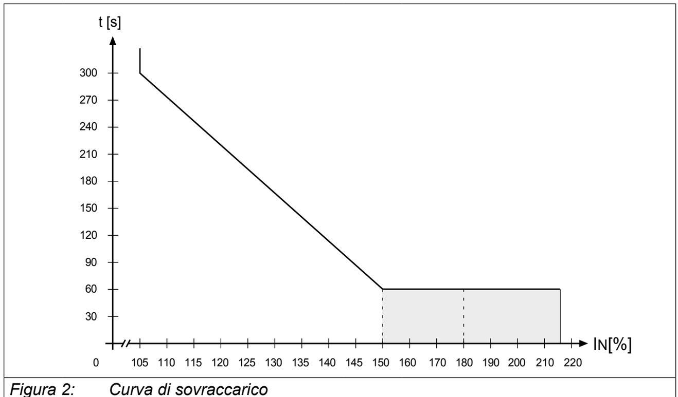
Il contatore si attiva col superamento del 105% di carico. Quando si ritorna a una condizione di carico inferiore, esso viene decrementato. Qualora l'integrale raggiunga la caratteristica di sovraccarico relativa all'inverter, verrà visualizzato l'errore „ERROR overload“.
