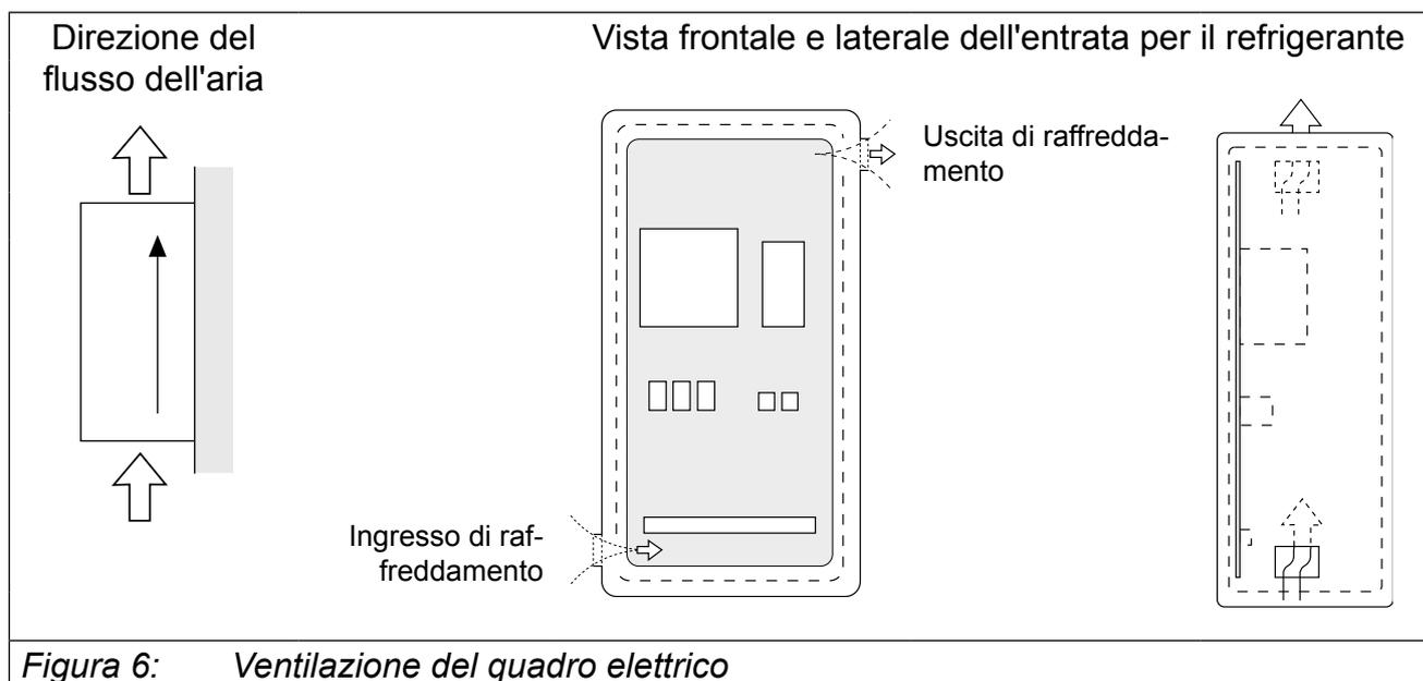
Figura 6: Ventilazione del quadro elettrico
