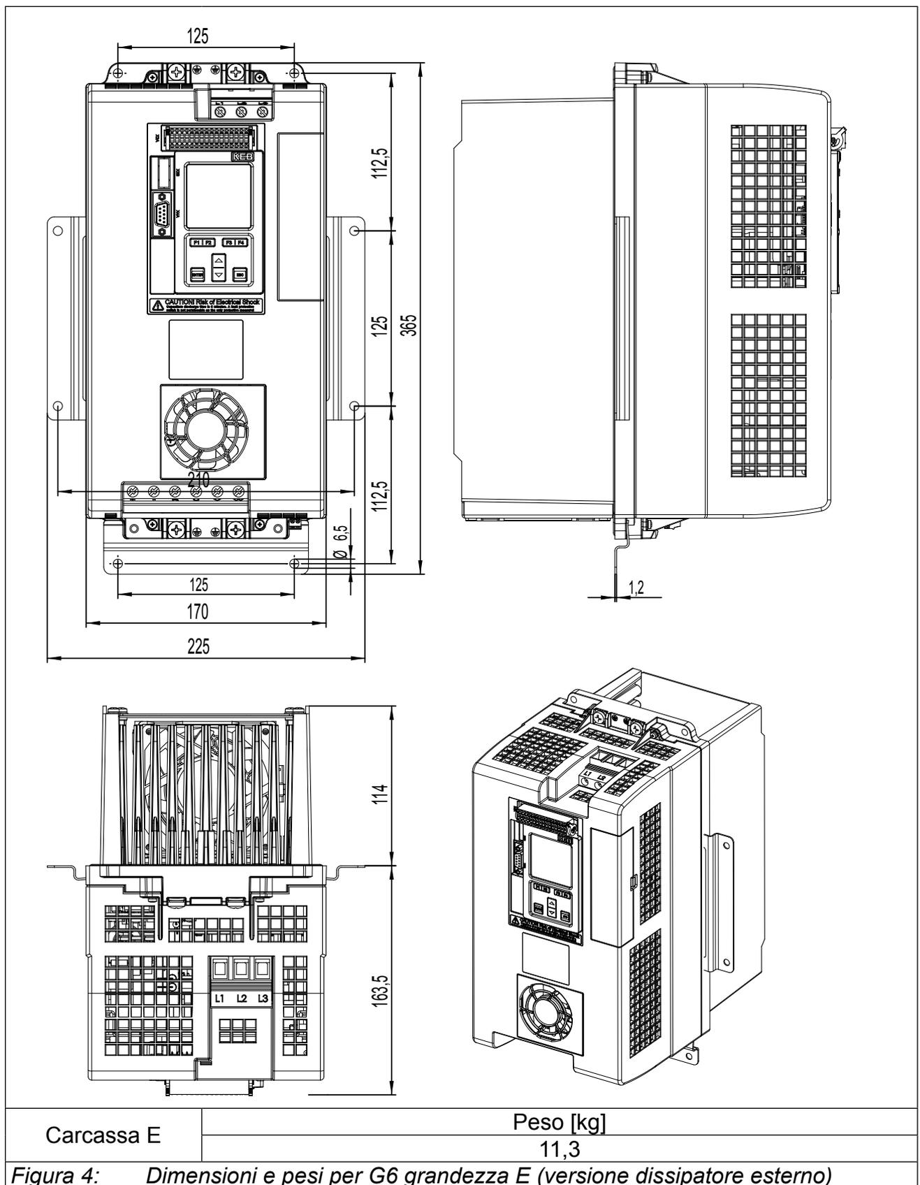
Figura 4: Dimensioni e pesi per G6 grandezza E (versione dissipatore esterno)
