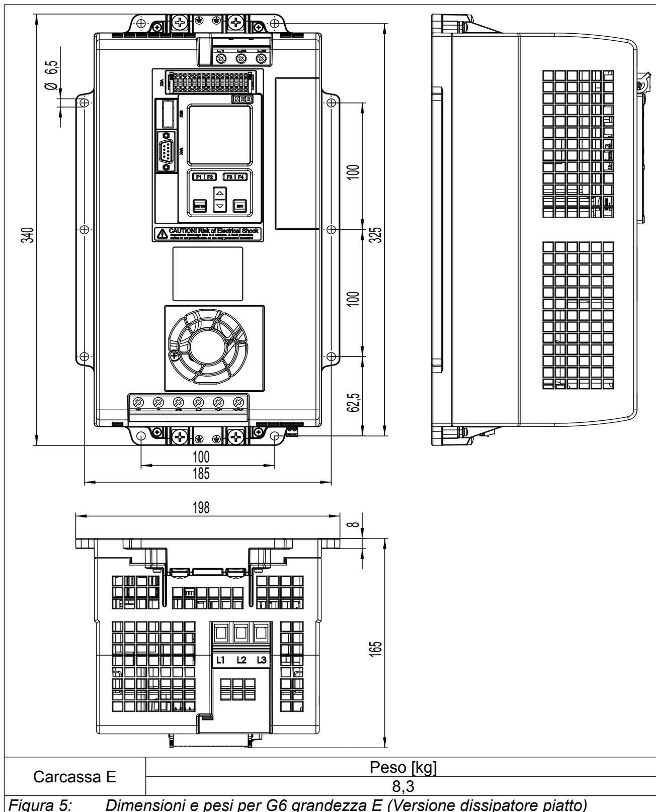
Figura 5: Dimensioni e pesi per G6 grandezza E (Versione dissipatore piatto)
