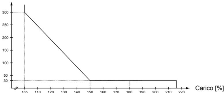
Il contatore si attiva col superamento del 105% di carico. Quando si ritorna a una condizione di carico inferiore, esso viene decrementato. Se raggiunge la caratteristica di sovraccarico dell'inverter, viene segnalato l'errore E.OL.
