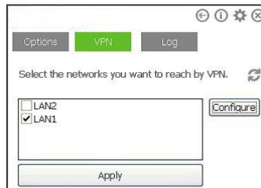
Die LAN1-Schnittstelle (Eth1/LAN) muss für den Anschluss an das Automatisierungsnetzwerk oder den Feldbus verwendet werden. Die beiden Schnittstellen können nicht vertauscht werden.
