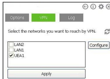
Das COMBIVIS connect Setup für C6 S14-Geräte ermöglicht standardmäßig die Installation des virtuellen COMBIVIS connect VPN Netzwerkadapters. Das VPN ist standardmäßig so konfiguriert, dass es mit diesem Adapter ausgeführt wird, ohne dass die physikalische Schnittstelle LAN1 gestört wird, die normalerweise von CONTROL Runtime für das Automatisierungsnetzwerk oder den Feldbus verwendet wird.
